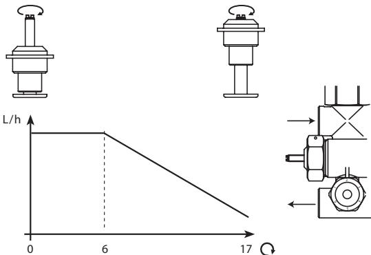
Для настройки расхода в узле FHM-Cx могут применяться регулятор расхода FH-FL и измерительная диафрагма FM-MS.
