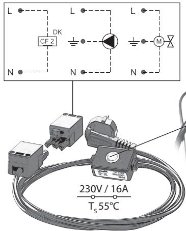
Термостат безопасности FH-ST устанавливают на подающем трубопроводе для защиты напольного покрытия и системы от слишком высоких температур, что особенно важно для деревянных полов.
